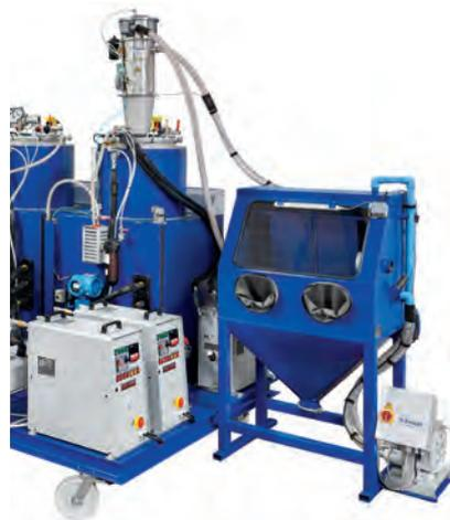
und einen kontinuierlichen Materialoutput zu liefern. In unserem Sortiment sind zwei Modelle mit einer Leistung von bis zu 0,5 kg/min oder 1 kg/min erhältlich.
