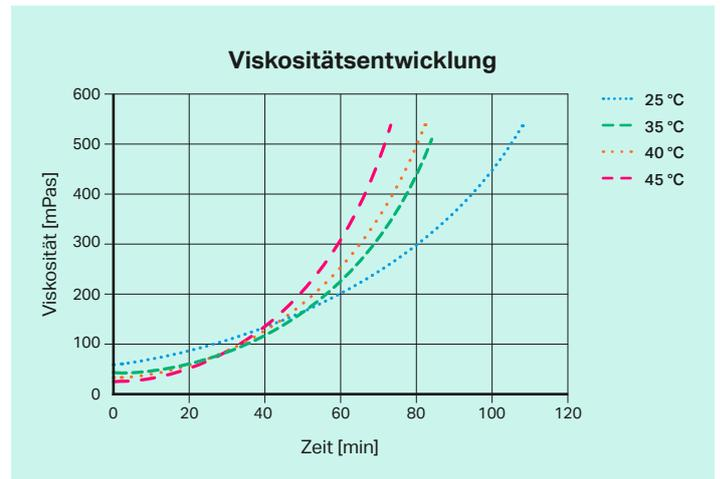
Die Viskosität wurde mit einem Brookfield DV2T-Viskosimeter mit kleinem Probenadapter (ca. 7 g Harz) gemessen.
