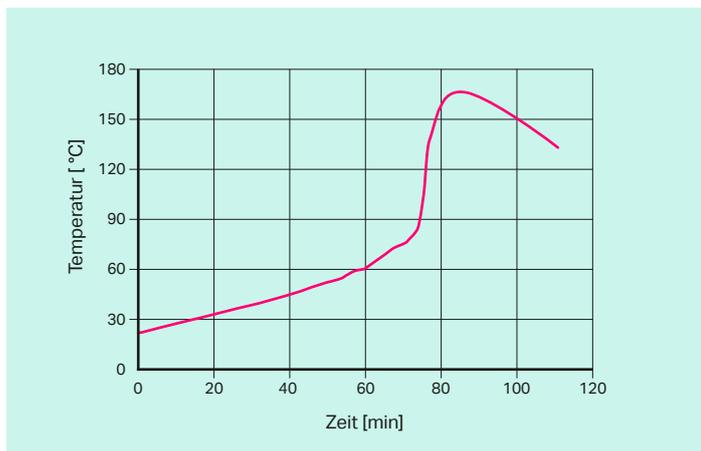
Die Temperatur des Harzes steigt nach dem Mischen aufgrund der exothermen Natur der Polyurethanreaktion langsam an. Die typische Temperaturentwicklung des Harzes bei Mischung in einem offenen Gefäß (nichtadiabatisch) geht mit einer langen Topfzeit einher und vermeidet kritische Hot Spots während der Infusion und Aushärtung.
