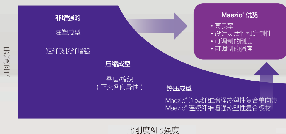
Maezio® 连续纤维增强热塑性复合材料加工及性能优势
