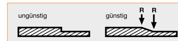
Bild 8: Gestaltung von Querschnittsübergängen
