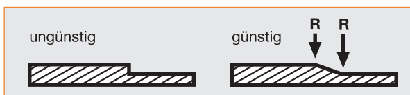
Bild 6: Gestaltung von Querschnittsübergängen
